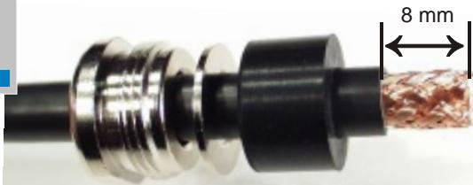
Mit einem Messer 8 mm des PVC-Mantels entfernen.
