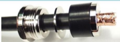
Kupfergeflecht im rechten Winkel hochbiegen. Kontakthülse zwischen Kupferfolie und Geflecht bis zum Anschlag einschieben. Überstehendes Geflecht abschneiden. Gummidichtung bis zur Kontakthülse nach vorne schieben.
