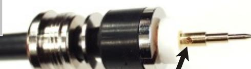
Teflonscheibe über Innenleiter schieben. Anschließend Innenstift aufstecken und sorgfältig durch das kleine Loch verlöten.
