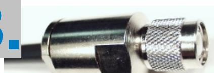
Das so vorbereitete Kabelende bis zum Anschlag in das Steckergehäuse einschieben. Mit zwei Maulschlüsseln 16 mm die Spannmutter handfest anziehen. Ein kleiner Spalt zwischen Mutter und Steckergehäuse sollte noch sichtbar sein!
