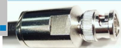
Das so vorbereitete Kabelende bis zum Anschlag in das Steckergehäuse einschieben. Mit zwei Maulschlüsseln 16 mm die Spannmutter handfest anziehen. Ein kleiner Spalt zwischen Mutter und Steckergehäuse sollte noch sichtbar sein!
