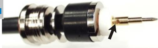
Teflonscheibe über Innenleiter schieben. Anschließend Innenstift aufstecken und sorgfältig durch das kleine Loch verlöten.
